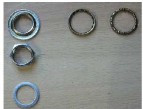
Les deux écrous, la rondelle et les deux roulements
